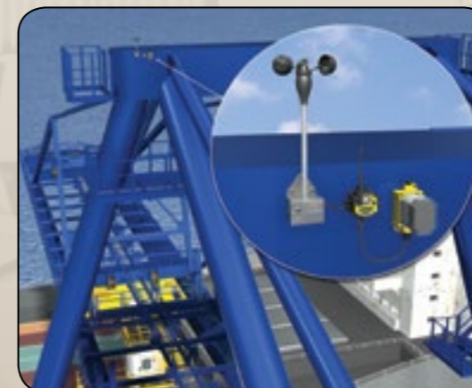
工作区域环境监测 风速数据通过无线从风速传感器发送至控制室。
