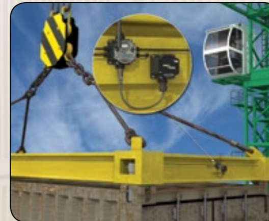
吊具上的四个称重传感器 交换称重传感器的信息和状态，以确保起吊前重量均匀分布在吊具上。
