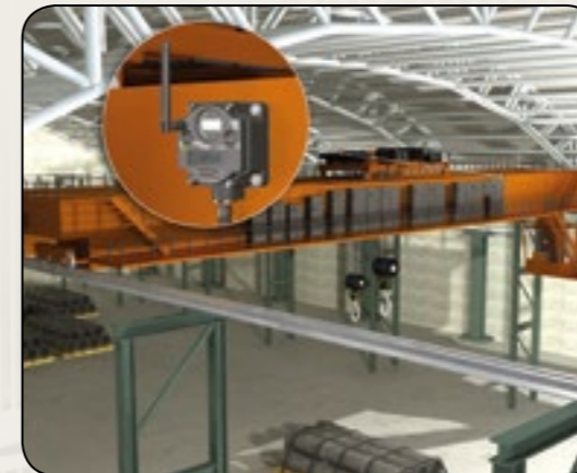
数据同步 桥式起重机控制器之间的位置数据同步，独立或串联的运动控制。
