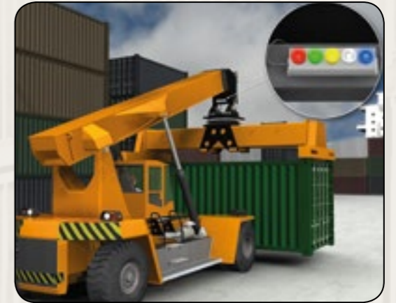
正面吊 高亮度指示灯让操作者在强光下也能清楚地看到吊车的状态
