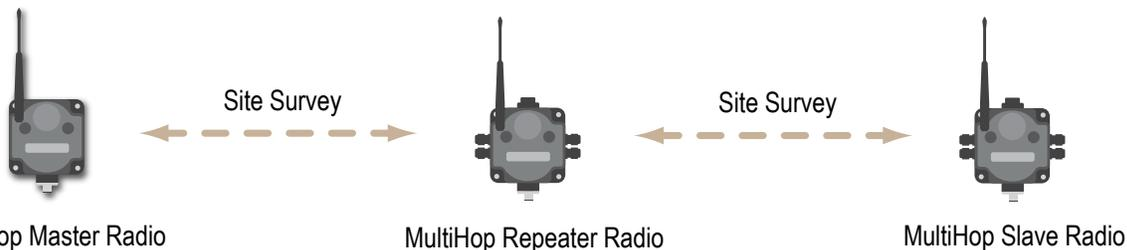
Andere innerhalb desselben Netzwerks verbundene Funkgeräte bleiben mit dem Netzwerk synchronisiert, werden jedoch während der Standortaufnahme für den Datenversand gesperrt. Bei der Standortaufnahme wird die Signalstärke nur zwischen dem ausgewählten untergeordneten Funkgerät und seinem zugehörigen übergeordneten Funkgerät analysiert. Bevor die Standortaufnahme beim nächsten Funkgerät durchgeführt werden kann, muss sie beim vorherigen Funkgerät deaktiviert werden.
