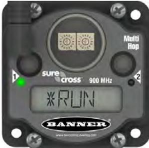
Bei der Netzeinschaltung nimmt das MultiHop-Funkgerät den Betrieb auf. Das Bildschirmdisplay blättert automatisch durch das \*RUN-Menü und die Kommunikation zwischen den Geräten wird aktiviert. Das automatische Blättern durch das \*RUN-Menü ist die normale Betriebsart für alle Geräte im Funknetzwerk.
