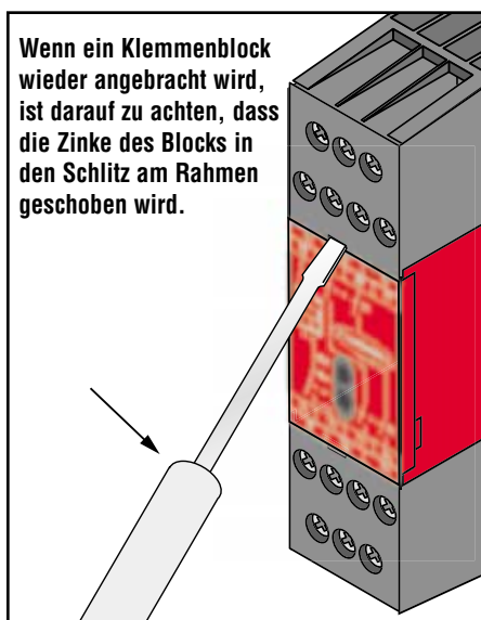
Abbildung 10. Zum Herausnehmen des Klemmenblocks einen kleinen Schraubendreher wie gezeigt in den Schlitz stecken und den Block loshebeln.
