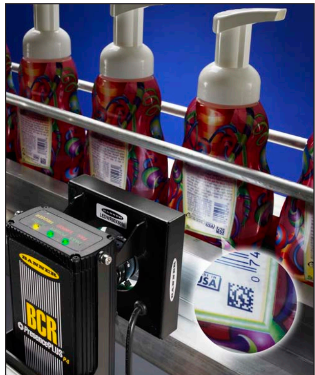
Abbildung 2-1. Typische Anwendung von PresencePLUS P4 BCR
