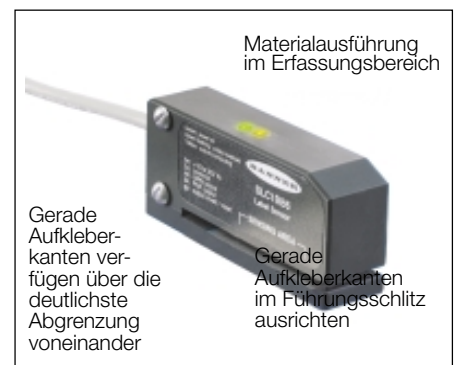
Abb. 3 Zur optimalen Erfassung sind die geraden Aufkleber-Kanten innerhalb des Führungsschlitzes auszurichten.
