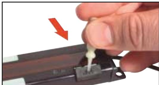
Figura 7. Rimozione coperchio PVA
