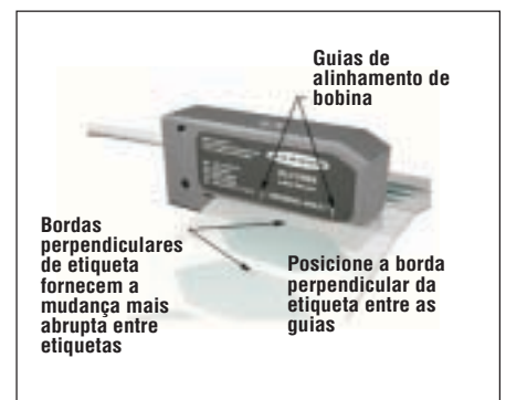
Fig. 3 Para melhor repetibilidade, alinhe os lados planos das etiquetas entre as guias de alinhamento de bobina do sensor
