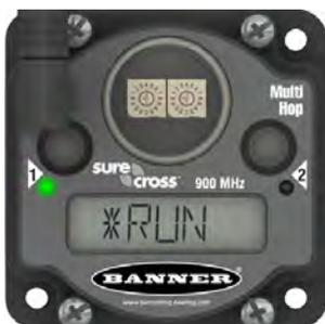
Les radios multi-sauts sont opérationnelles dès leur mise sous tension. L'écran fait automatiquement défiler le menu \*RUN, puis la communication entre les appareils est activée. Le défilement automatique du menu \*RUN correspond au mode de fonctionnement normal de tous les appareils du réseau sans fil.
