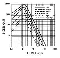
Figure 15. PBT26U-Diffuse Mode
