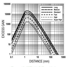
Figure 17. PBT46U-Diffuse Mode
