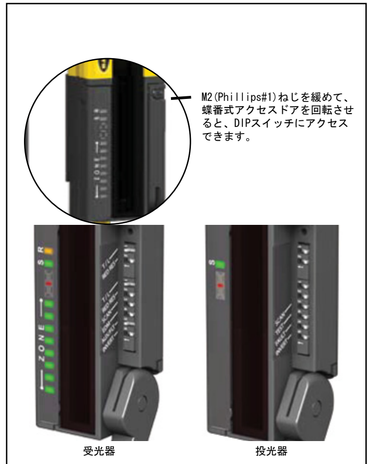
Fig. 4-1 設定スイッチへのアクセス
