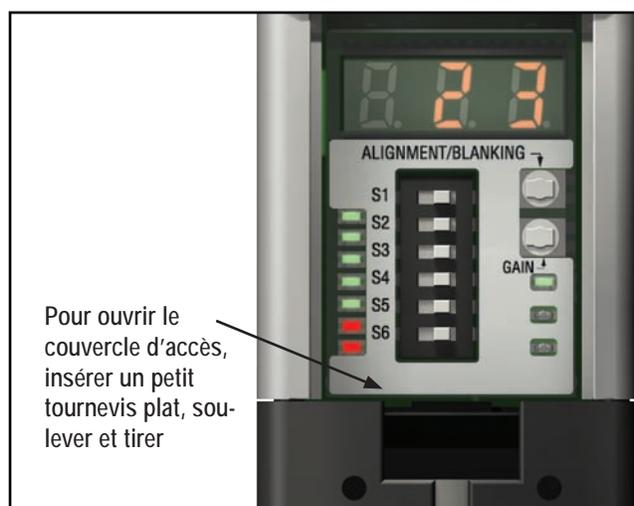
Figure 4-1. Interface utilisateur du récepteur. NOTE : Toutes les positions du micro interrupteur DIP sont illustrées sur ON.
