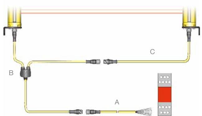
D'autres schémas de raccordement sont possibles: les câbles A peuvent être utilisés individuellement pour la connexion des E/R, sans les câbles pieuvres.
