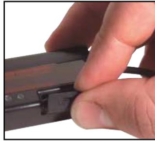
Abbildung 8. Ausrichtung der PVA-Abdeckungskante
