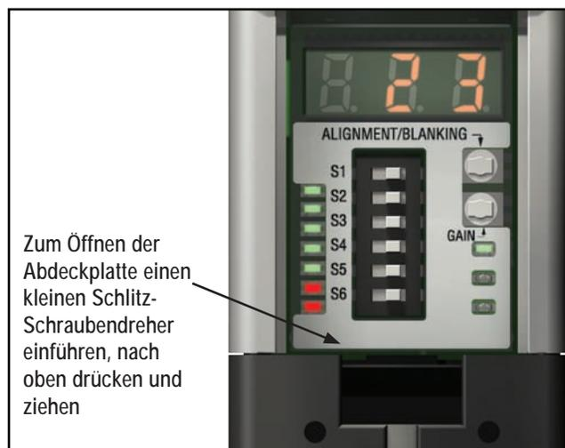
Abbildung 4-1. Empfänger-Benutzeroberfläche. HINWEIS: Alle DIP-Schalterpositionen sind im AN-Zustand dargestellt.
