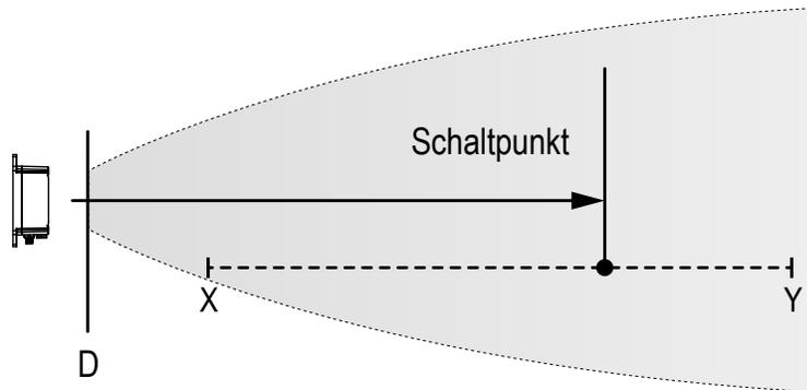
Abbildung 2. R-GAGE-Schaltpunktentfernungen
